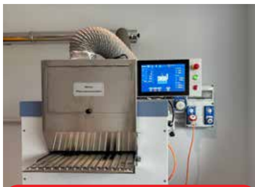
Mathis Oven per i test di stabilità termica statica
